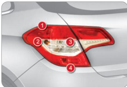
1. **Stop svetlo/poziciono svetlo (P21/5W).**
