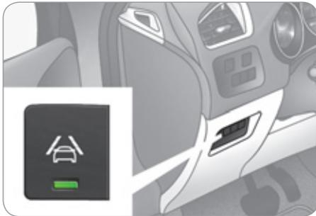
Sistem koji detektuje neželjeni prelazak uzdužne oznake na putu (neprekidna ili isprekidana linija).
