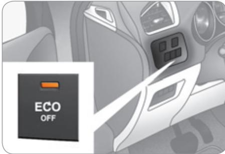
U slučaju neispravnosti sistema, signalna lampica na komandi "ECO OFF" trepće, a zatim trajno svetli.
