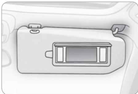
Uređaj za zaštitu od sunca u prednjem ili bočnom delu i ogledalu sa osvetljenjem na unutrašnjoj strani štitnika.
