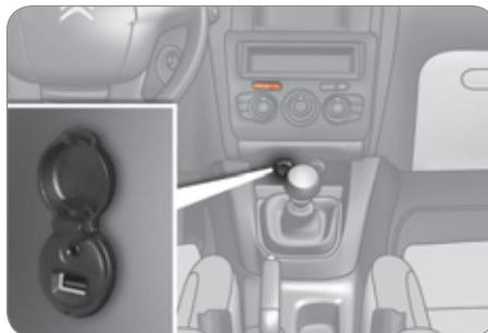
Ovo kućište za konekciju "AUX", postavljeno od utičnice JACK i/ili USB priključka, nalazi se na centralnoj konzoli. Omogućava vam uključivanje prenosive opreme, kao što su numerički vorkmen tipa iPod® ili USB ključ.
