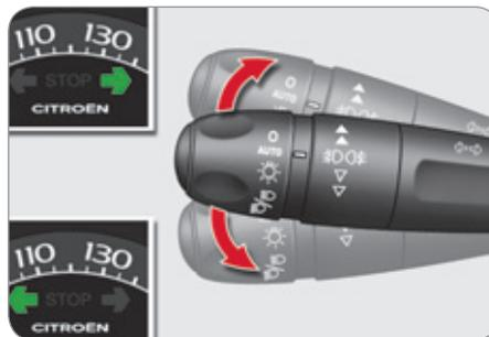
Podižite i spuštajte ručicu za svetla prelazeći svaki put preko tačke otora ; odgovarajući migavci će se paliti i gasiti dok je ručica u toj poziciji.
