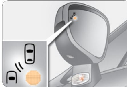
Fiksni svetlosni signal se prikazuje u retrovizoru na onoj strani gde se pojavljuje drugo vozilo :
