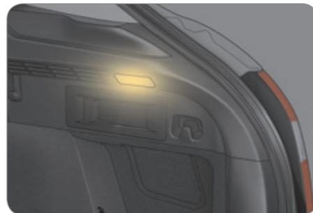
Svetlo se pali automatski otvaranjem prtljažnika i gasi se automatski njegovim zatvaranjem.
