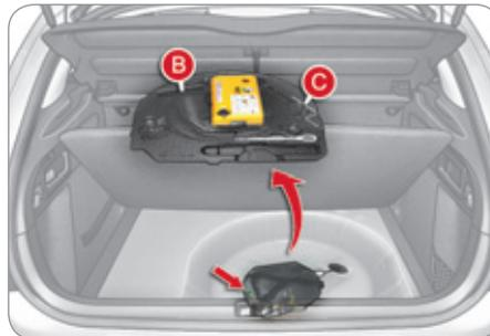
U slučaju neispravnosti električne parkirne kočnice ili kvara akumulatora, pomoćni mehanizam, koji je smešten u dnu prtljažnika omogućava da se ručno otpusti parkirna kočnica.
