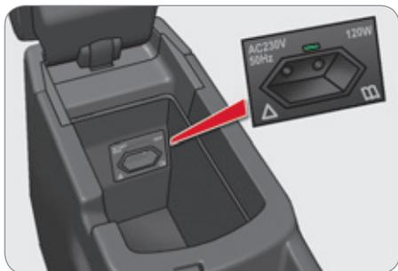
Utičnica 230 V/50 Hz (maksimalna snaga : 120 W) je instalirana na centralnoj konzoli.
