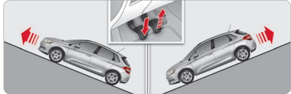
**Na uzbrdici, dok je vozilo zaustavljeno, ono ostaje zakočeno kratko vreme nakon otpuštanja papučice kočnice :**
