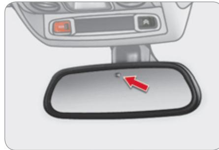
Zahvaljujući posebnom senzoru kojim se meri stepen osvetljenosti koji dopire sa zadnje strane vozila, ovaj sistem obezbeđuje automatski i postepeni prelazak sa dnevne na noćnu upotrebu.
