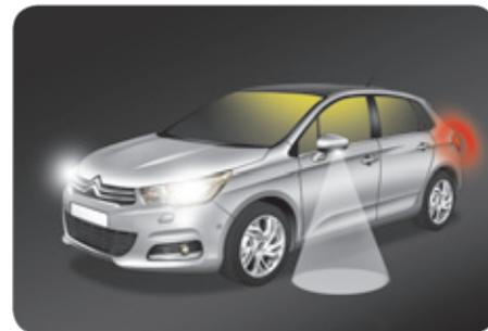
U slučaju slabe vidljivosti, koju otkriva detektor, daljinsko paljenje kratkog i pozicionog svetla, kao i bočnih svetala, olakšava Vaš dolazak do vozila.
