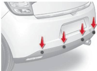
Sustav otkriva svaku prepreku (osobu, vozilo, drvo, ogradu...) iza vozila, osim prepreka neposredno ispod branika.
