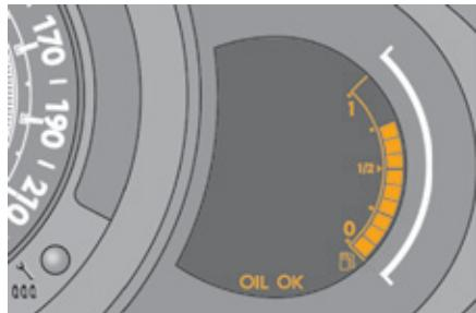
U izvedbama s električnim mjeračem, ispravnost razine motornog ulja prikazuje se na nekoliko sekunda na ploči s instrumentima prilikom uključivanja kontakta, nakon podatka održavanju.
