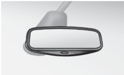
Zahvaljujući davaču koji mjeri svjetlo koje dolazi sa stražnje strane vozila, retrovizor automatski i postupno prelazi iz dnevne u noćnu podešenost i obratno.
