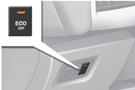
U slučaju neispravnosti sustava, žaruljica na tipki "ECO OFF" bljeska, zatim ostaje stalno upaljena.
