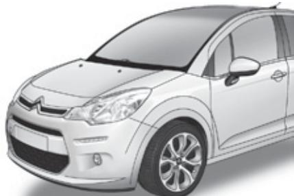
Panoramski vjetrobran od zatamnjene stakla povećava osvijetljenost i vidljivost u kabini. Opremljen je sjenilom koje se namješta ručno, radi boljeg toplinskog komfora, i zaslonom za sunce koji štite od zasljepljivanja.
