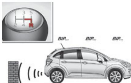
Sustav se uključuje, uz zvučni signal, nakon postavljanja ručice mjenjača u stupanj prijenosa za vožnju natrag. Podatak o blizini prepreke dojavljuje se:
