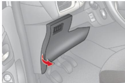
Štipaljka i mesta rezervnih osigurača nalaze se na poleđini poklopca kućišta osigurača u armaturnoj ploči.
