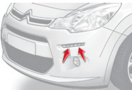
Nakon pokretanja motora, dnevna svjetla danju se automatski pale, ako je sklopka svjetala u položaju "0" ili "AUTO".
