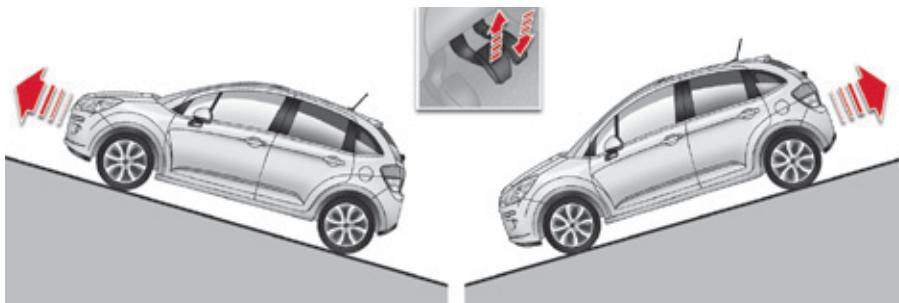
**Na uzbrdici, dok vozilo miruje, ono ostaje zakočeno kratko vrijeme nakon otpuštanja papučice kočnice:**
