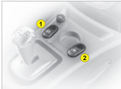
1. Prekidač električnog podizača prozora vozača.
