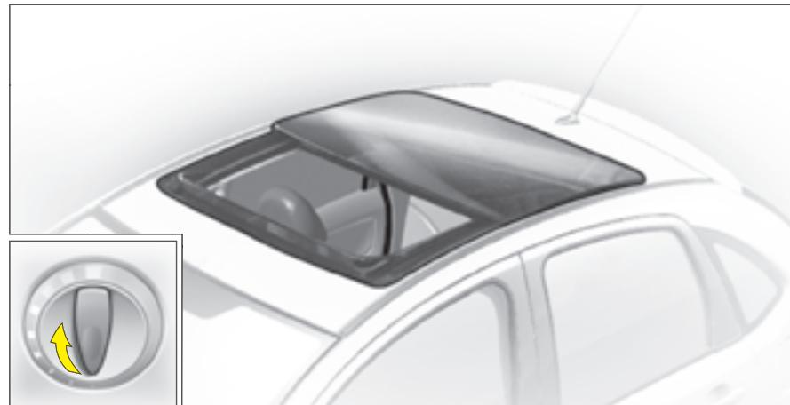
Sklopka za električno sekvenčno upravljanje otvorom na krovu s devet položaja otvorenosti smještena je na oblozi krova, između dva prednja zaslona za sunce.
