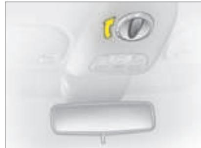
Okretanjem sklopke ulijevo krovni otvor pomiče se klizanjem.
