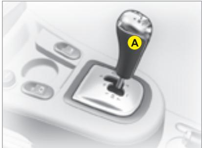
Ručni robotizirani mjenjač s pet stupnjeva prijenosa nudi izbor komfora u automatskom načinu rada ili užitka u ručnom mijenjanju stupnjeva prijenosa.
