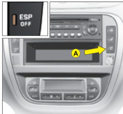
Taj sustav pridružen je sustavu ABS i on djeluje zajedno sa sustavom ABS. U slučaju odstupanja između stvarne putanje vozila i one kakvu želi vozač, sustav ESP automatski djeluje na kočnicu jednog ili više kotača, kao i na motor, kako bi vozilo zadržalo željenu putanju.
